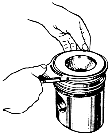
Рис. 85. Снятие и надевание поршневых колец
